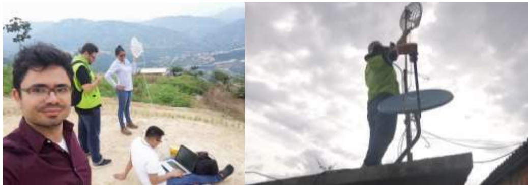
Ilustración 12 Pruebas de transmisión y enlace para la conexión en tiempo real entre la estación Campo Hermoso y la sede de la Universidad de Santander.
